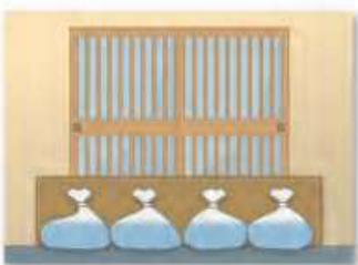
簡易水防工法例② 簡易水のう+止水板 簡易水のうを作り、長めの板などと組み合わせて出入口に設置し、浸水を防ぎます。
