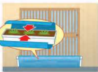
簡易水防工法例① プランター+ビニールシート 土を入れたプランターをビニールシートで巻き込んだものを使用し、浸水を防ぎます。
