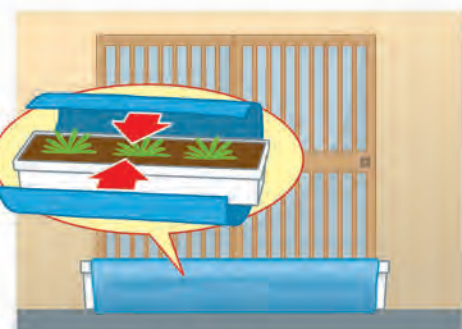
簡易水防工法例① プランター+ビニールシート
