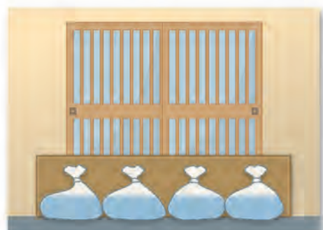
簡易水防工法例② 簡易水のう+止水板
