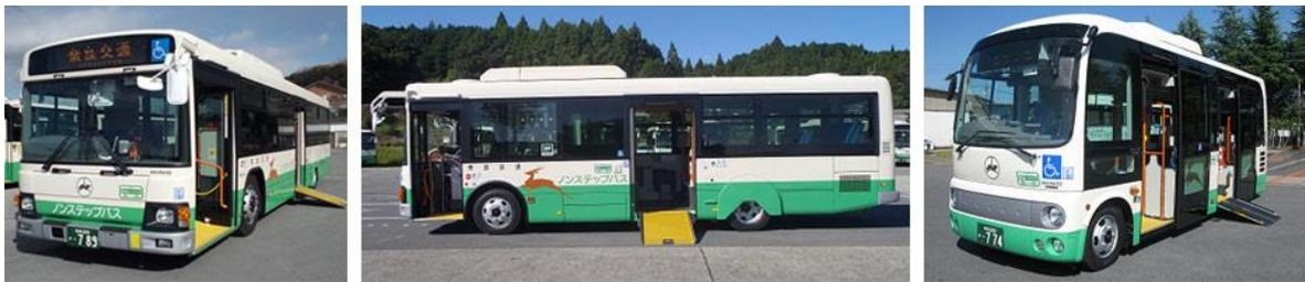
図-8-2 ノンステップバスの例（奈良交通 HP より）
