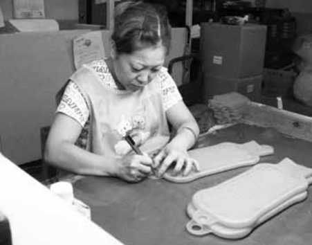
型をとった水枕から、 周囲にある余分なゴムを 手作業で取り除きます
