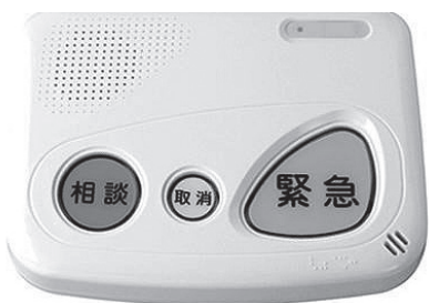
固定電話タイプの緊急通報システム
